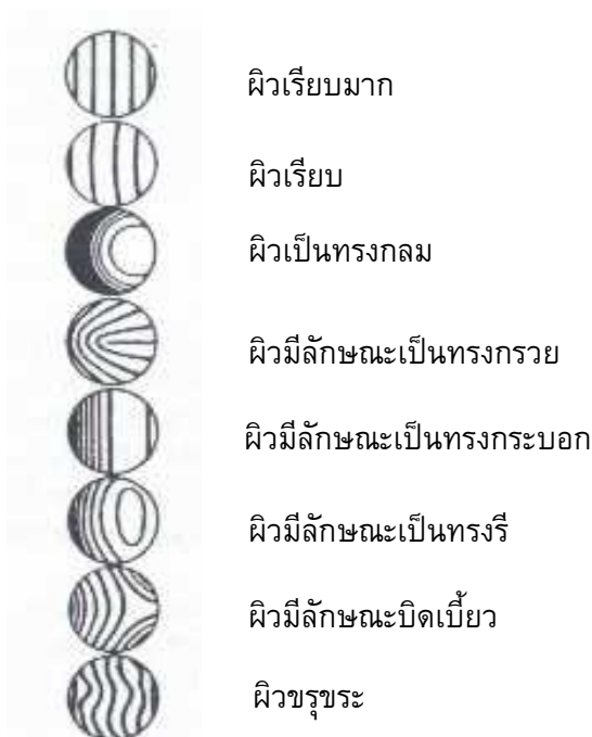
รูปที่ 3 แสดงลวดลายการแทรกสอดที่เกิดจากผิวลักษณะต่างๆกัน[1]
